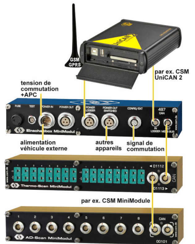
Montage exemple : modules de mesure et enregistreur CSM
